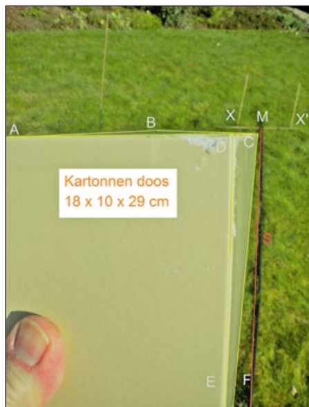
Foto 1 (links) - Het vlak ABCD is in lijn met XMX, zodat het verlengde van vlak CDEF de snijlijn S met de grond aangeeft.
