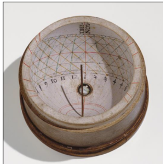
Fig. 4. Een draagbaar zonnwijzertje voor Bazelse, Babylonische en Italiaanse uren, met een ingebouwd kompasje. (Foto: Historisches Museum Basel.)
