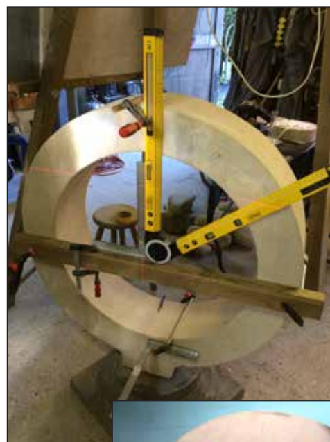
Foto 1: Uitlijnen met het laserwaterpas en de hoekmaat.
