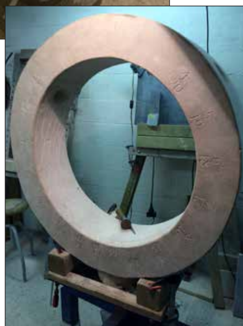
Foto 2: Stenen ring met uurcijfers, uurlijnen en uitgang oculus.
