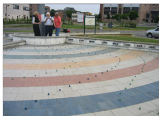
Fig. 2. Azimutale zonnewijzer in Reggio Emilia. Per halve maand is er een urencirkel. De maandnamen zijn rechts te lezen. De uurnummers staan langs de buitenrand, achter de rug van de fotograaf. De man met de rode polo is de ontwerper, Renzo Righi.
