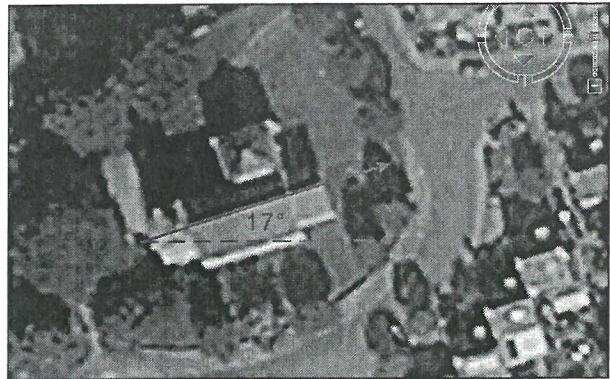
Fig. 4. Bepaling van de asrichting van de Oude Jan: 17° noord van oost. Naast de kerk zijn de schaduwen van de toren en de kapel duidelijk zichtbaar.
