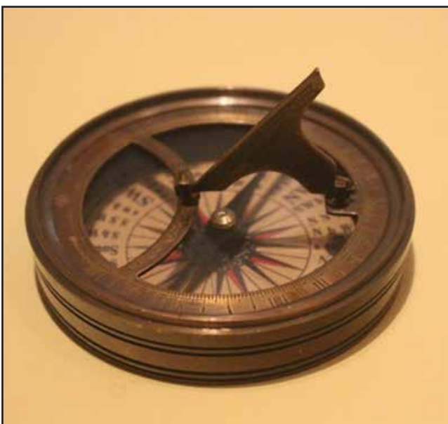
Foto 4: kompaszonnwijzer in de verzameling van een van onze leden. Hier hoort een schroefdekseltje bij.
