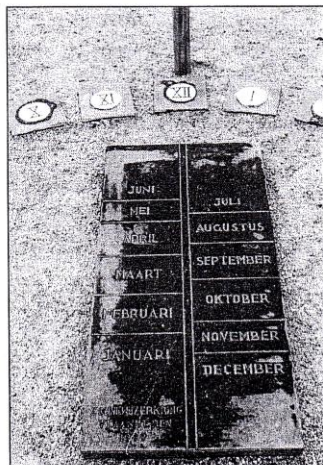
Fig. 2. De arduinen plaat met de datumschaal vormt een betere oplossing dan de losse stenen waarover het informatiebordje rept, want bij regen spoelt de grond gauw weg. De datumschaal lijkt veel te lang, maar in feite loopt hij van de lijn onder "juni" tot de lijn boven "december".
