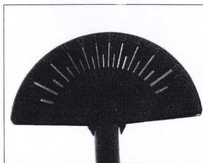
Fig. 2. De spleten van 3 uur en 3.30 uur lichten beide op, de laatste iets meer. De aflezing is ca. 3.20 uur.
