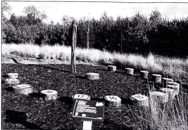
Fig. 7. Interactieve uurvlakzonnwijzer in het recreatiegebied Het Keelven bij Someren (NL). Aan de paal zit een touw dat de bezoeker strak trekt. De boomstronk rechts van de paal is het inplantingspunt van de (virtuele) poolstijl. Als de schaduw van het strakgetrokken touw over dit punt valt, wijst deze het juiste uur aan (hier zomertijd). De foto is ontleend aan [5].
